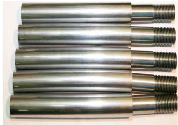
Рис. 3.31. Внешний вид деталей из углеродистой стали марки Сталь 3 после обработки волочением с применением МСК «Валена»
