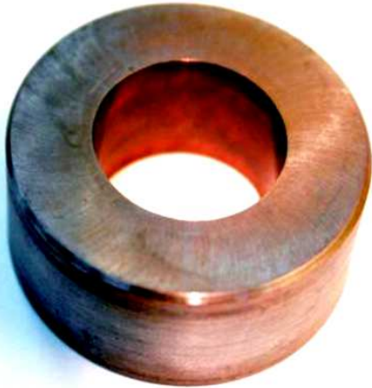
Рис. 3.30. Внешний вид деформирующей фильеры с РМР после обработки партии образцов-заготовок из стали марки Сталь 3 с МСК «Валена» (K=25%)
