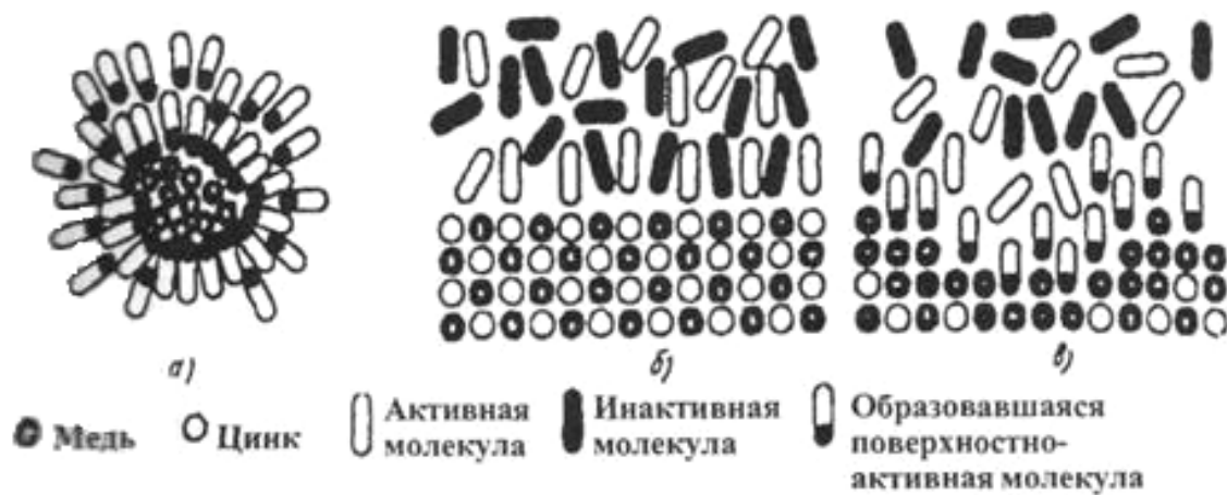
Рис. 2.11. Мицеллообразование и взаимодействие поверхностно-активных веществ с бронзовой поверхностью:
