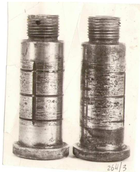
Рис. 2.4. Задиры болтов шарнирного сочленения самолета типа ТУ на поверхностях трения
