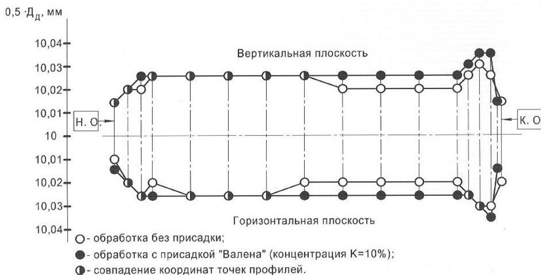
Рис. 3.25. Характерные профили образцов-заготовок из углеродистой стали марки Сталь 3 при i_{\phi} \approx 0,25 мм
